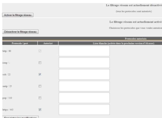
Figure 82 - Paramétrage du Pare-Feu
